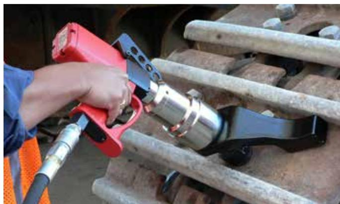
Die Werkzeuge PTM-80, PTM-92 und PTM-119 bringen den Geschwindigkeitsvorteil des Zweimotorhandgriffs auf die PneuTorque® Modelle mit höherer Kapazität. Diese Modelle bieten eine ideale Kombination aus Robustheit, Geschwindigkeit und Gewicht.
